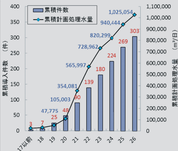
図2 紫外線処理設備導入状況(浄水プロセス) 2)
