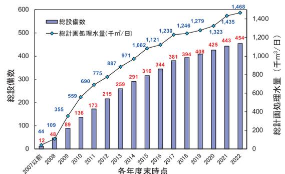
図3 紫外線照射装置の総設備数と総計画処理水量の推移 (2022年度末時点)
